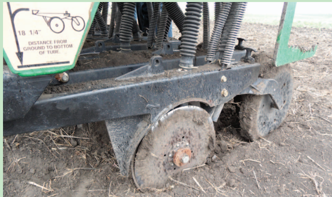
Двухдисковый самозатачивающийся сошник для исключения попадания пожнивных остатков в сеялки – важный элемент технологии No-till.
