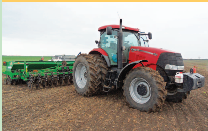
Спаренные колеса на всей технике – еще одно золотое правило технологии No-till.
